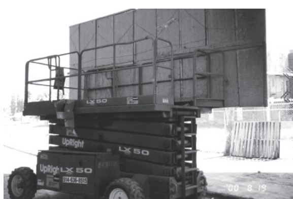
Figure 9.9-6 Écran sur nacelle en ciseau
