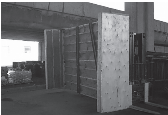
Figure 9.9-5 Écran sur chariot élévateur
